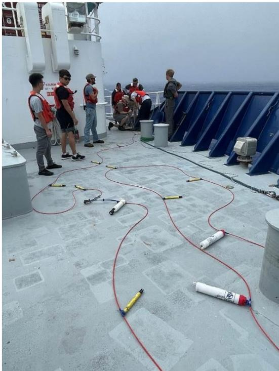
附圖二、船舶拖曳式溫度串(Bow Chain)施放。
