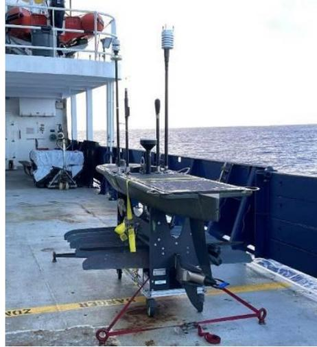
附圖五、新型自走式海洋觀測載具—wave glider。
